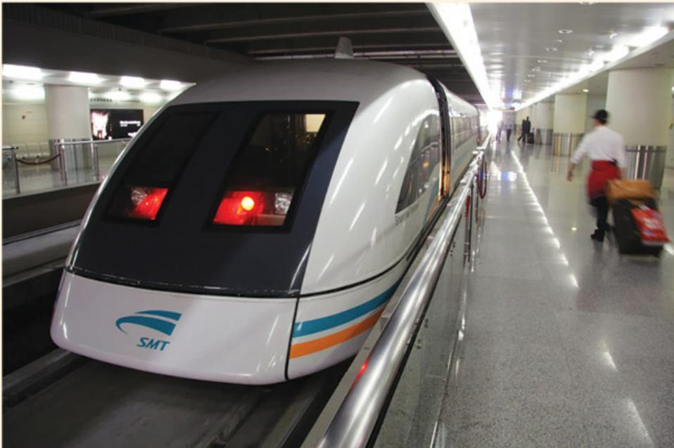
El tren *Maglev* (del inglés *magnetic levitation*, término que significa **levitación magnética**) puede llegar a desarrollar velocidades de hasta 500 km/h.
