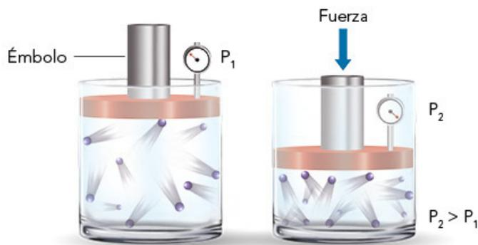
7 Efectos de la aplicación de una fuerza externa a un gas. El dispositivo con manecilla asociado al pistón se conoce como manómetro y mide la presión del gas.
